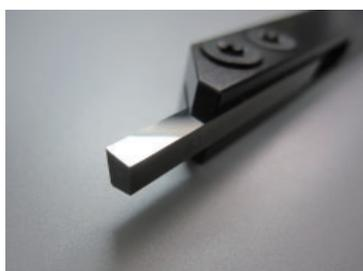
写真2 ブレードの上面を鏡面研磨
