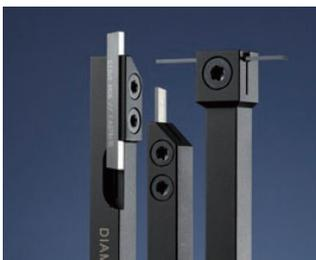
ダイヤデックはダイヤモンド社の自動旋盤用ブレード式工具で、全長 40mm のブレードを、スライド式のホルダに組み付けて突切り・溝入れ用の工具（バイト）として使用する。突出し量を自由に設定可能で、刃先をユーザが任意の形状に再研磨して使用することが出来る。ホルダは 4 種類あり、剛性を確保した標準タイプ、芯高を設定
