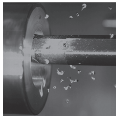
図4 内径旋削加工におけるEB-TOOLの切りくず排出の様子（YouTube「セミドライ加工でコスト削減！」参照）
