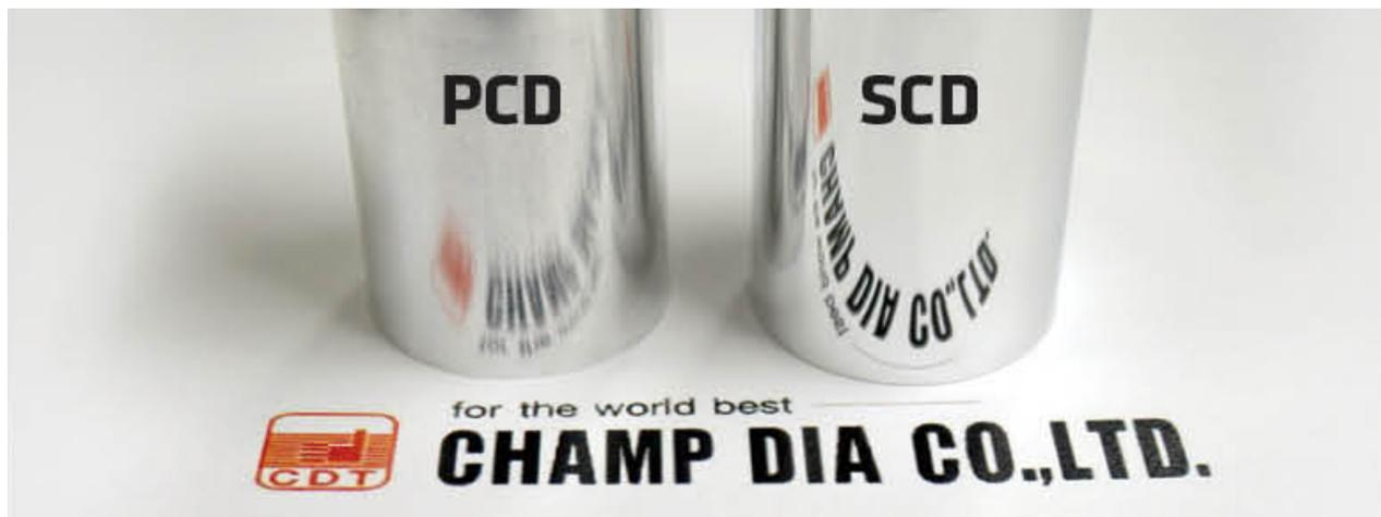
\*PCD（多結晶ダイヤモンド）とSCD（単結晶ダイヤモンド）のアルミの仕上げ加工。
