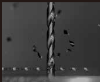
セミドライ × 小径深穴の切りくず排出
