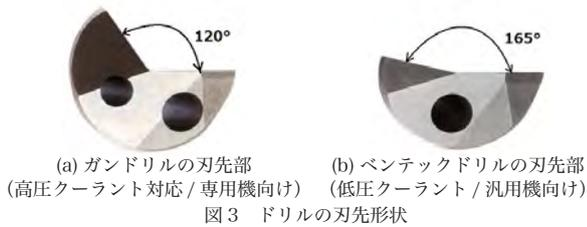
ベンテックドリルの特徴は、刃の開き角度が165°で一般的なガンドリルの切れ刃角(110°～120°)に比べてかなり大きい点にある(図3)。剛性は低下するが切りくずの排出性を高めたことで、汎用機でエア供給圧0.5MPa以上のクーラントの圧力でも切りくずを排出し、切りくず詰まりを抑制し、ドリル折損を軽減している。なお、穴あけの工作機械については、ドリル切りくずの排出が容易な横型を推奨している。
