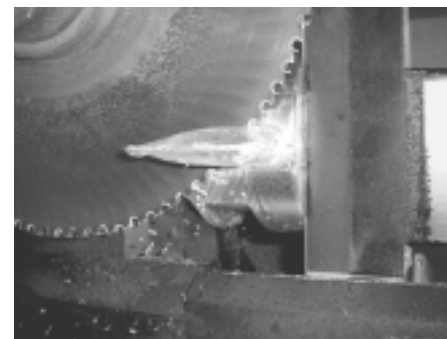
【写真1】ピストン鑄造後と加工後 下 湯口切断
